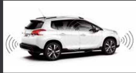
Задние датчики системы помощи при парковке
